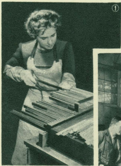
На фоне авторских свидетельств, выданных заводским изобретателям, показаны некоторые усовершенствования, предложенные горьковскими автомобилестроителями. 1. Ручная сборка радиаторов; она выполнялась таким образом до изобретения автомата. 2. Автомат для сборки корпусов радиаторов грузового автомобиля, сконструированный группой заводских изобретателей. 3. Станок, созданный слесарем С. П. Козловым для обработки кольцевых канавок в шарнирных соединениях. 4. Автомат для сборки пластин бензофильтра.
